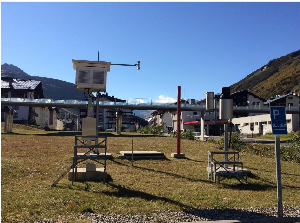
*Abb. 16: Die hydrometeorologische Station Zürs des Hydrographischen Dienstes Vorarlberg samt Schneemessfeld befindet sich im Bereich der Talstation der Hexenbodenbahn. Im Hintergrund ist die rote Schneemesslatte mit einer Höhe von drei Metern erkennbar.*
