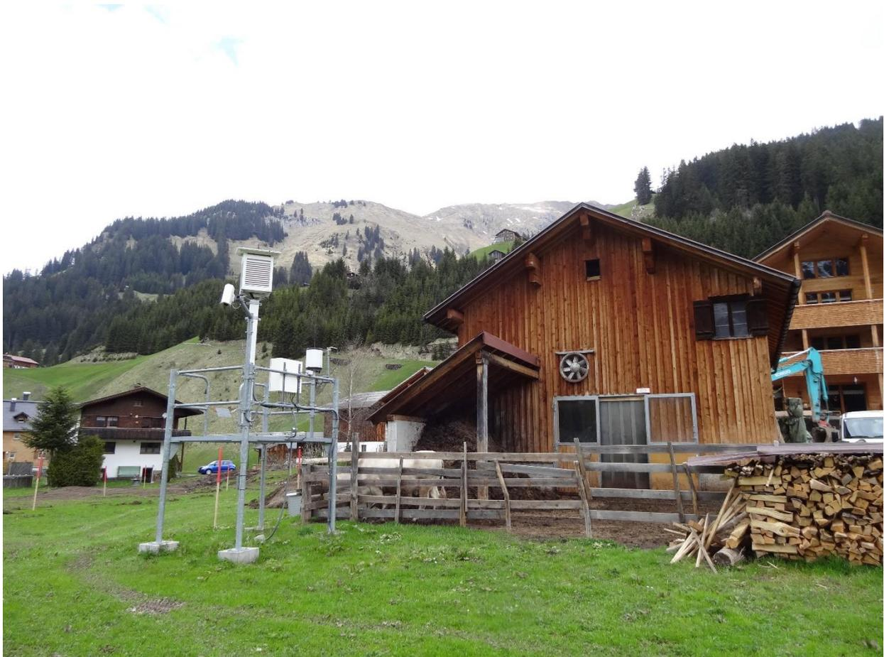
Abb. 25: Die hydrometeorologische Station der ZAMG in Schröcken. Das Schneemessfeld befindet sich zwischen der automatischen Station im Vordergrund und dem Haus hinten links. Foto: ZAMG.
