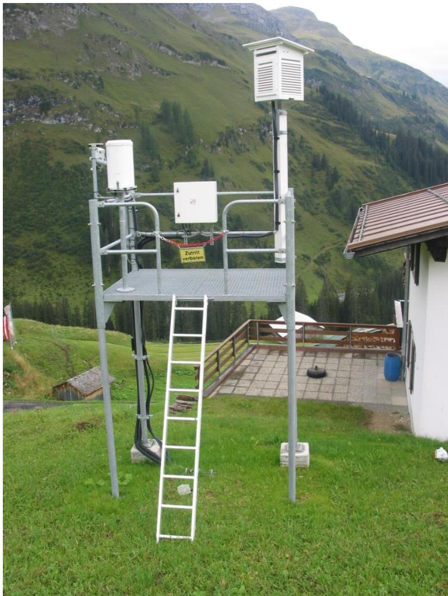
Abb. 21: Die hydrometeorologische Station der ZAMG in Warth. Das Schneemessfeld befindet sich unterhalb der Station auf der ebenen Fläche im Vorfeld der Terrasse. Foto: ZAMG.
